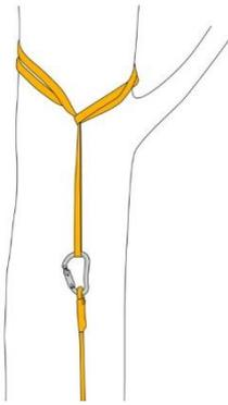
Fig. 3 - Possibile variante dello strozzo diretto della fune
